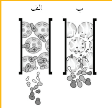
شکل ۲: دو روش کروماتوگرافی کلاسیک الف- کروماتوگرافی تبادل یونی، تفاوت در بار پروتئین‌ها باعث جداسازی است. ب- کروماتوگرافی اندازه‌طردي، اندازه پروتئین‌ها باعث جداسازی است.
