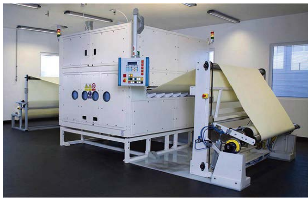
شکل (۱۰): دستگاه الکتروریسی بدون سوزن ساخت شرکت المار کو کشور چک [۱۲ و ۲۴].
