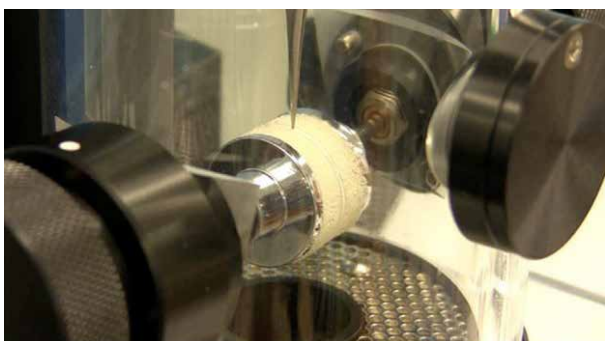
شکل ۱۰: نمای داخل محفظه جذب مقدار اضافی نمونه سوسپانسیون [۴].
