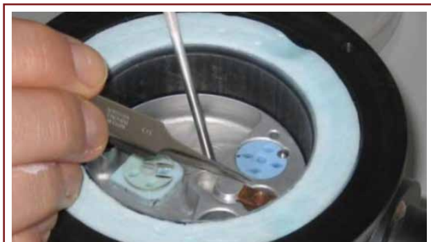
شکل ۱۴: چگونگی قرار دادن گرید درون Cryo-Specimen Holder [۴].
