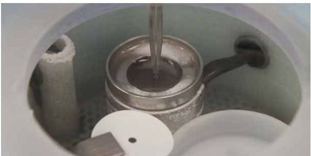
شکل ۱۱: نمای داخل محفظه پر شده از اتان مایع که اطرافش را نیتروژن مایع فرا گرفته است [۴].
