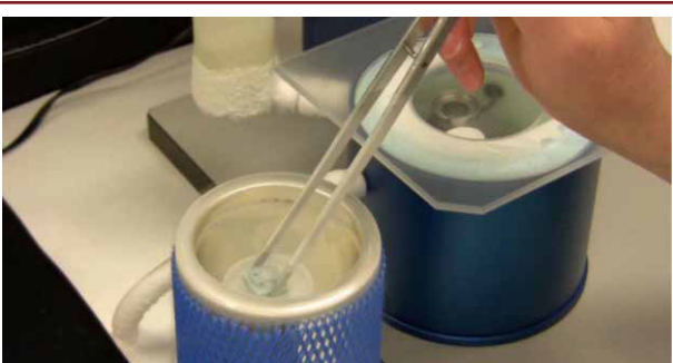
شکل ۱۲: انتقال گرید آماده شده به Cryo-Specimen Holder با مخزن حامل [۴].
