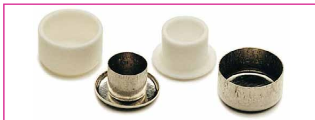
شکل (۲۴): ظروف آزمون پلاتینی و آلومینا با حجم های مشخص [۱].
