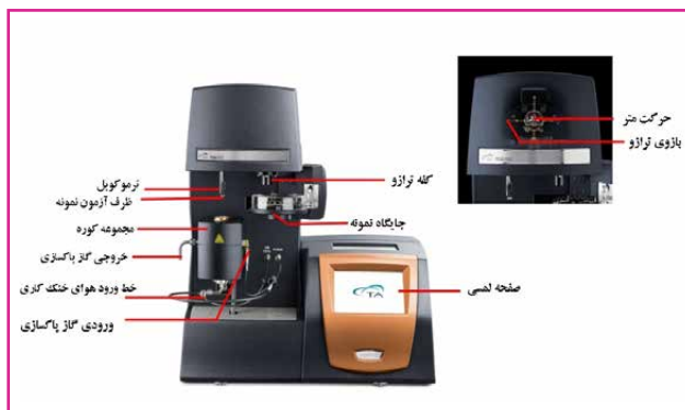
شکل (۵): طرحواره دستگاه تحلیلگر گرماوزن سنجی [۱].
