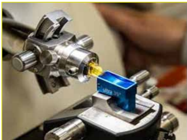
شکل (۱): برش زدن و ایجاد لایه نازک با دستگاه اولترامایکروتوم.
