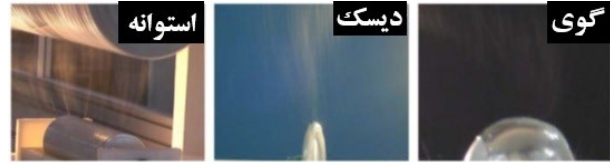
شکل (۹): تصاویر الکتروریسی بدون نازل با استفاده از رشته‌سازهای متفاوت استوانه‌ای، دیسکی و توبی [۱۲].
