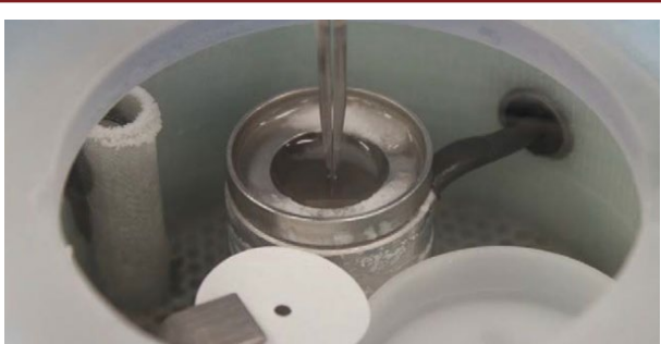
شکل ۱۱: نمای داخل محفظه پر شده از اتان مایع که اطرافش را نیتروژن مایع فرا گرفته است [۴].
