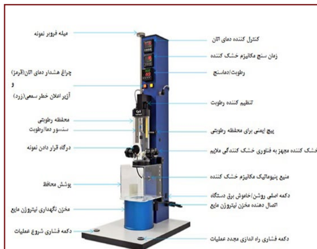
شکل ۷: نمونه‌ای از دستگاه خودکار مورد استفاده برای عملیات PF نمونه‌های سوسپانسیون (دستگاه فروبر کرایو) [۴].
