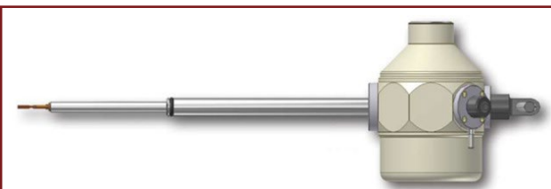
شکل ۶: ساختار ابزار جانبی نگهدارنده نمونه کرایو [۴].
