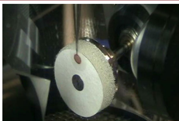
شکل ۹: مرحله جذب مقدار اضافی نمونه سوسپانسیون با کاغذ فیلتر درون محفظه [۴].
