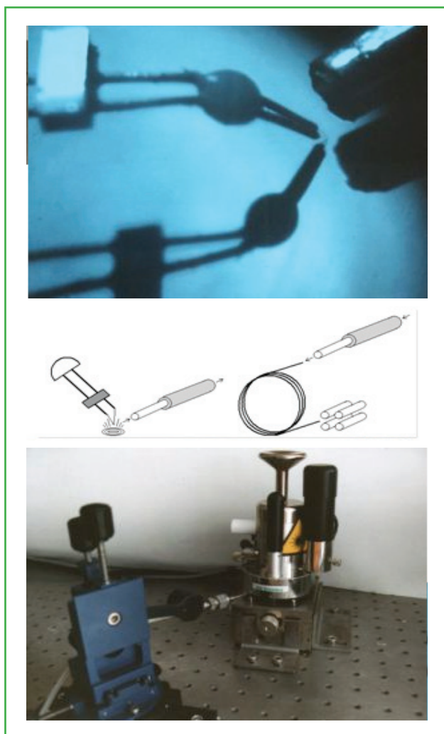
شکل ۱۰: دستگاه شناسایی گاز متصاعد شده از نمونه مورد آزمایش برای تجزیه شیمیایی به‌وسیله گرما در روش آنالیز ریز حرارتی [۴].
