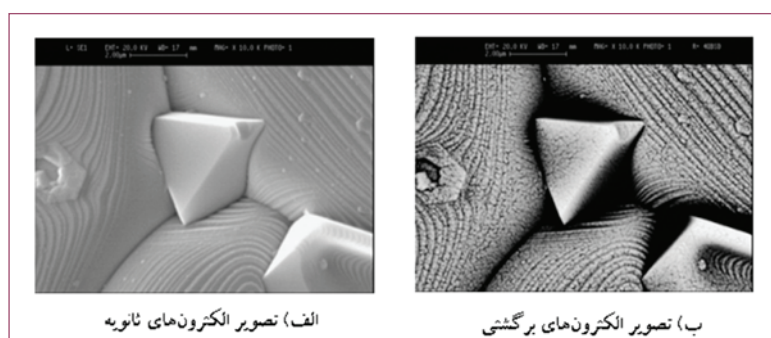
شکل (۱۶): تصاویر حاصل از الکترون‌های ثانویه و برگشتی آلیاژ قلع
