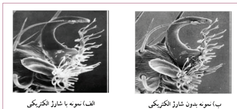
شکل (۱۷): اثر شارژ الکتريکی در نمونه پای ملخ [۳]
