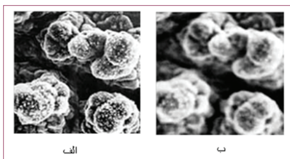
شکل (۳۳): شکل (الف) بدون مشکل آستیگماتیسم و (ب) دارای مشکل آستیگماتیسم [۱۰]
