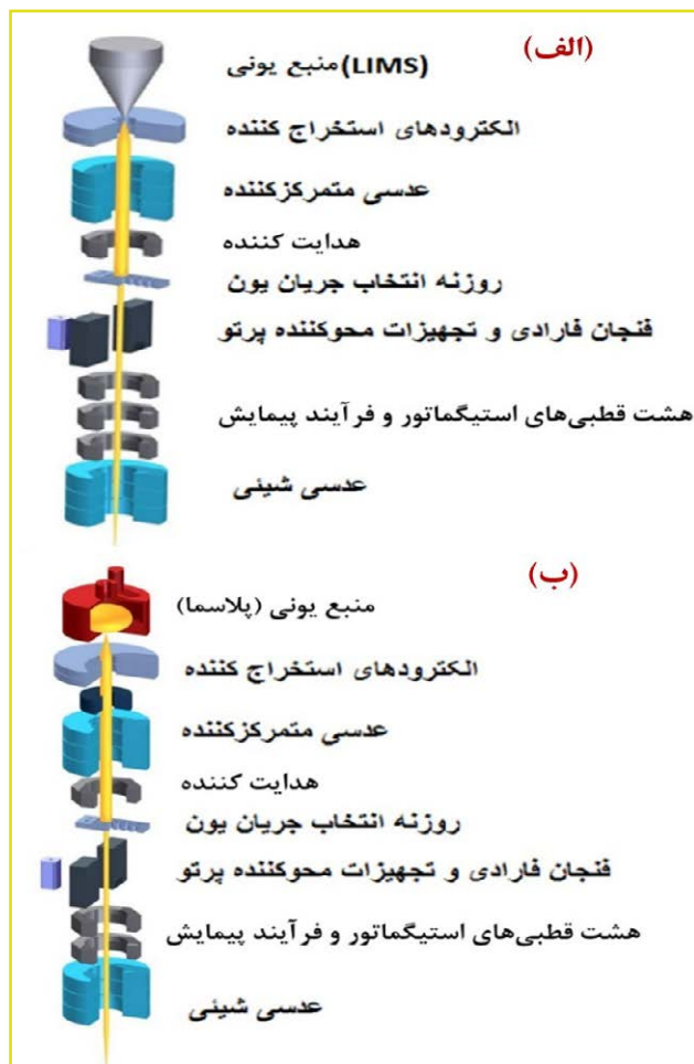
شکل (۲): نمایی از ستون FIB. (الف): ستون FIB دربرگیرنده منبع یونی (LIMS) و (ب): ستون FIB دربرگیرنده منبع یونی پلاسما [۳].
