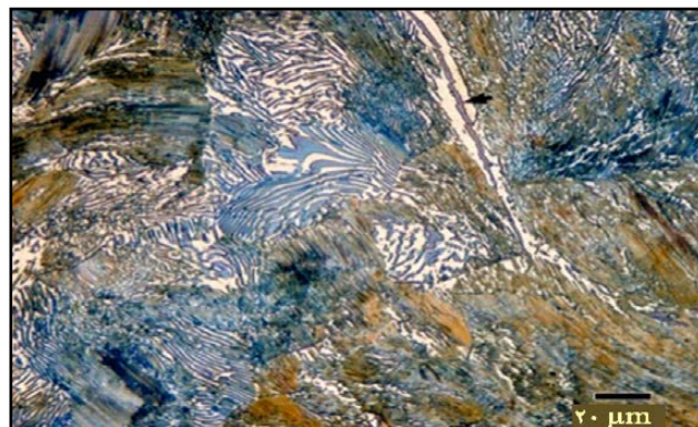
شکل (۱۵): ریزساختار فولاد ۱ درصد کربن نوردی اچ شده با براها مولیبدات سدیم [۱].
