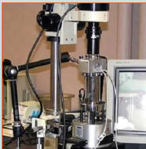
شکل (۱): میکروسکوپ نیروی اتمی برای اندازه‌گیری کشسانی [۴].
