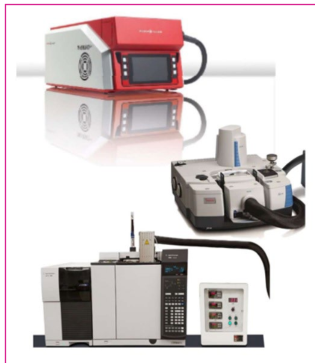
شکل (۲۶): دستگاه‌های قابل اتصال به TGA شامل طیف‌سنج جرمی، طیف‌سنج فروسرخ با تبدیل فوریه و کروماتوگرافی گازی - طیف‌سنجی جرمی [۱].
