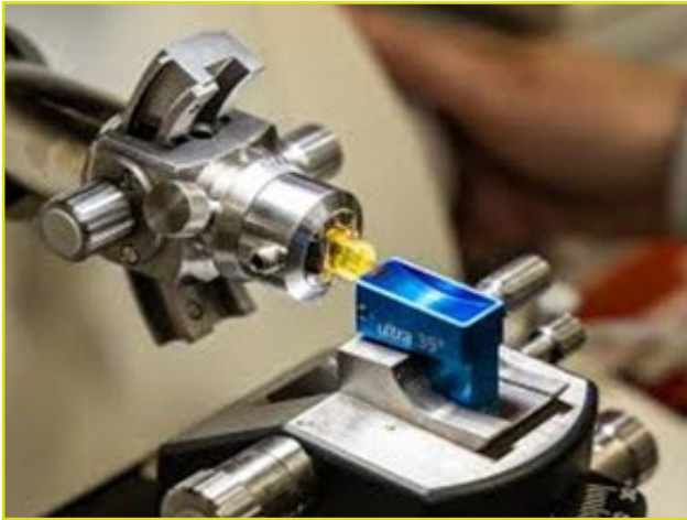
شکل (۱): برش زدن و ایجاد لایه نازک با دستگاه اولتراماکروتوم.
