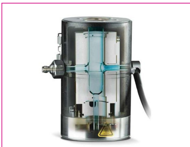
شکل (۸): کوره EGA با نرخ جریان ترازو/نمونه: ۹۰/۱۰ میلی لیتر بر دقیقه [۱].
