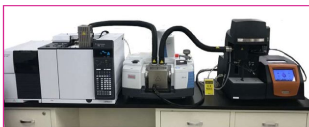
شکل (۲۹): آنالیز TGA همراه با FTIR و GC-MS [۱].
