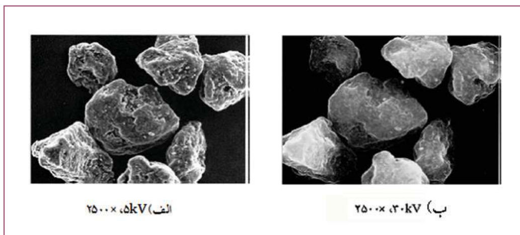
شکل (۴): اثر ولتاژ شتاب‌دهنده (الف) در ولتاژ بالا دیدن ساختارهای سطحی مقدور نیست و سطح نمونه شارژ دارد (ب) ریزساختارهای سطحی با استفاده از ولتاژ پایین مشاهده می‌شوند [۳].
