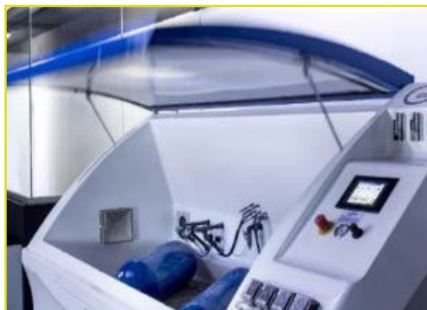
شکل (۱۸): نمایی از دستگاه آزمون مه نمکی [۶].
