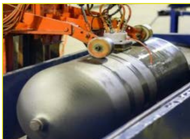
شکل (۱۰): نمایی از دستگاه آزمون ترک‌یابی مخازن به روش فراصوت [۲].
