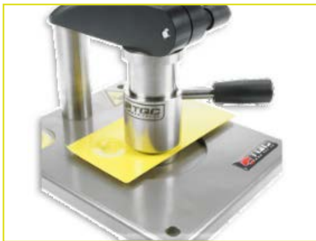
شکل (۱۷): دستگاه آزمون ضربه رنگ و پوشش [۱۹].
