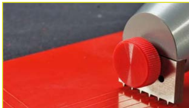
شکل (۱۵): چگونگی انجام آزمون چسبندگی با روش کراس کات [۱۷].
